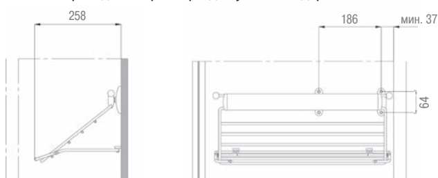
Присадочные размеры для установки держателя
