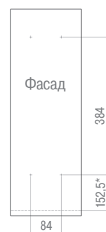
Присадочные размеры для установки фасада
